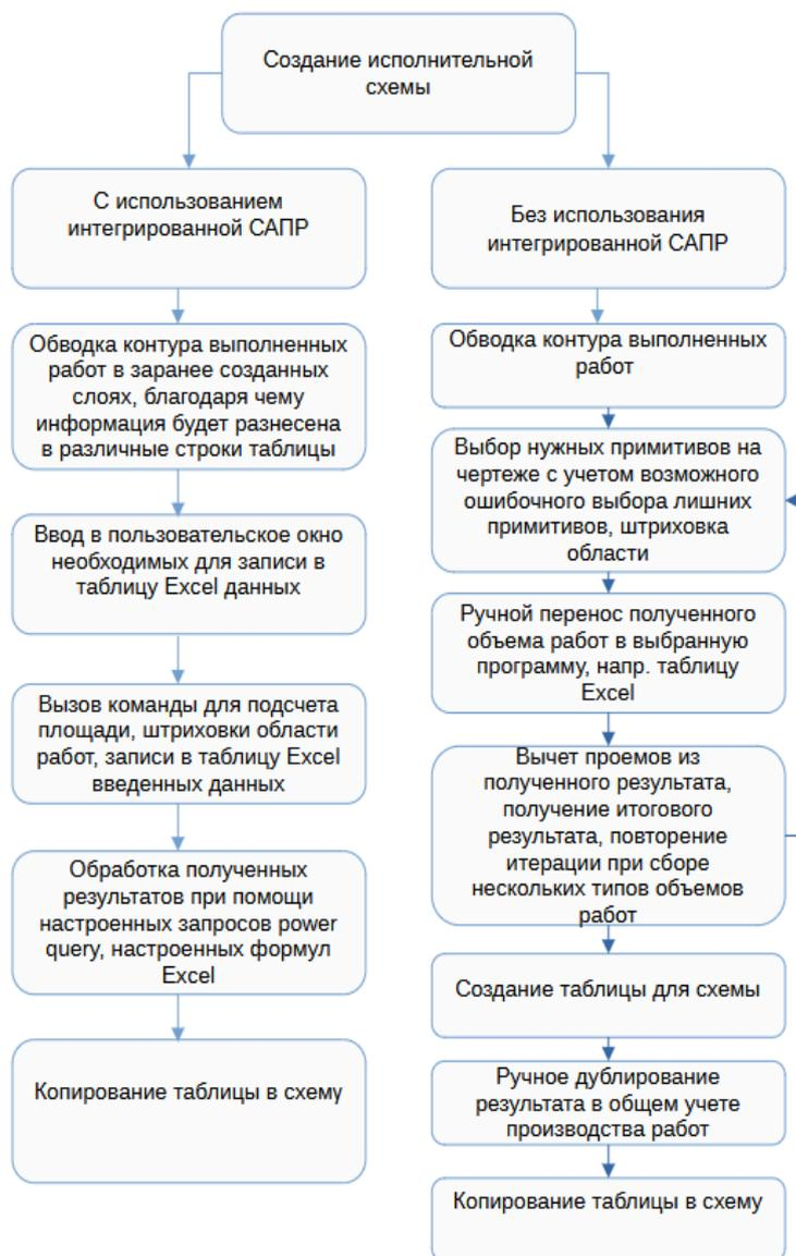
**Рис. 2.** Схема сравнения создания исполнительного чертежа с использованием и без использования интегрированной САПР
