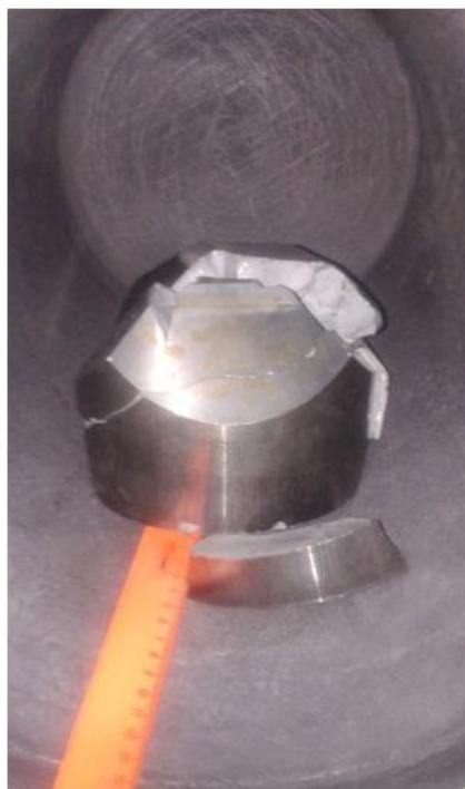
*Рис. 2.* Металлокерамические отходы в графитовом стакане на деструкции
