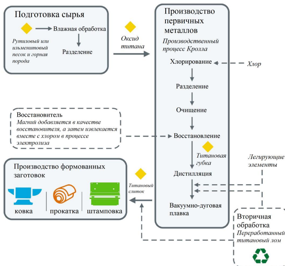
Рис. 1.1. Технологический процесс производства титана
