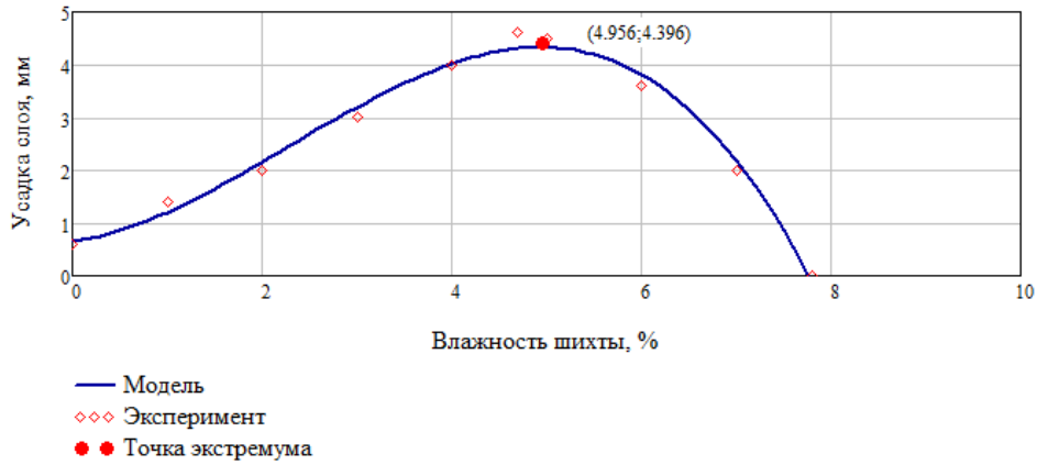
Рис. 4.4. Влияние влажности шихты \omega (%) на усадку слоя шихты \Delta h (мм)
