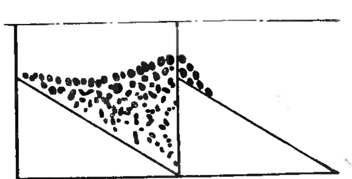
Рис. 2.3. Распределение материала в конусах барабанного окомкователя
