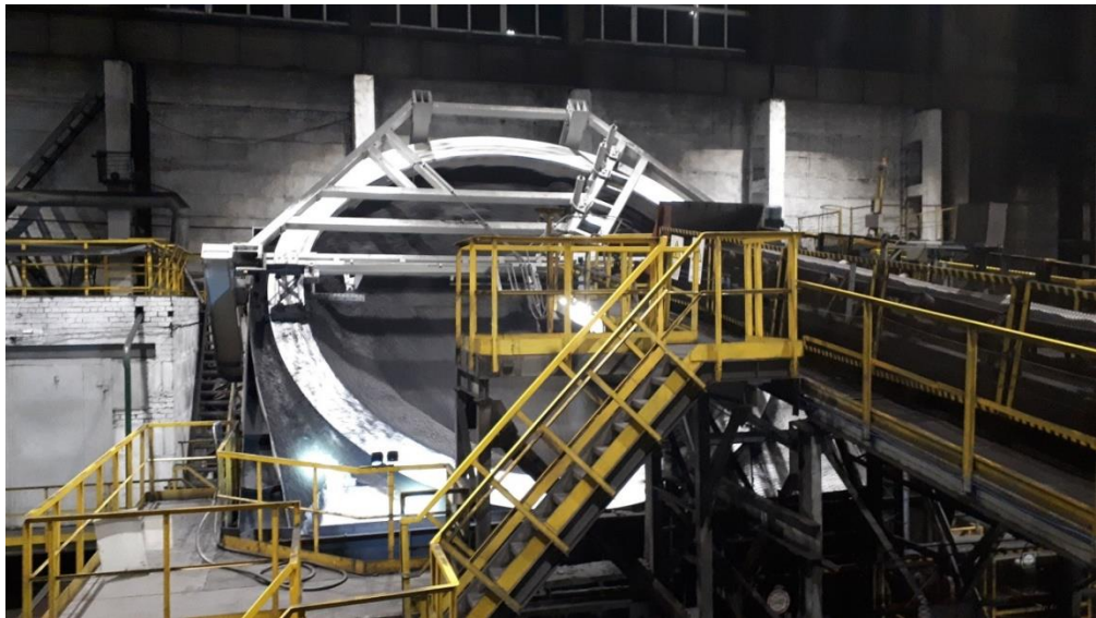
Рис. 1.7. Дискový окомкователь Scarabaeus компании HAVER & BOECKER NIAGARA
