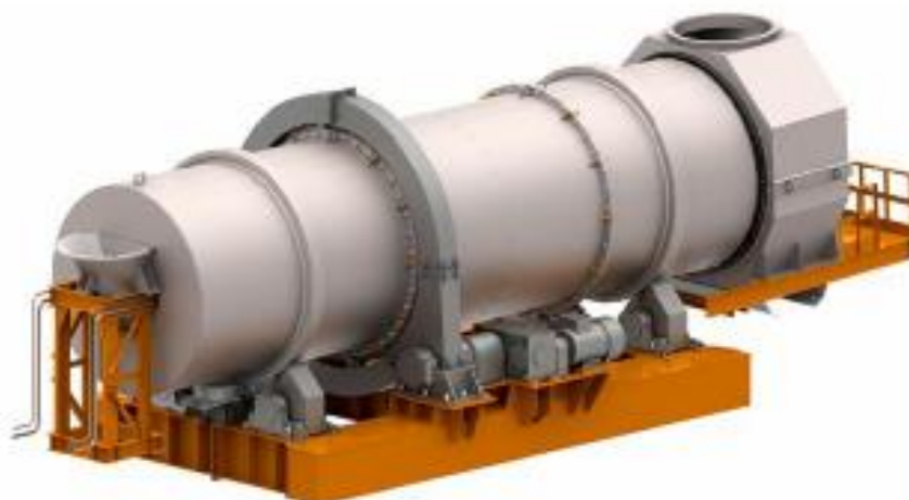
Рис. 2.2. Окомкователь барабанного типа ОБ-3,2x12,5
