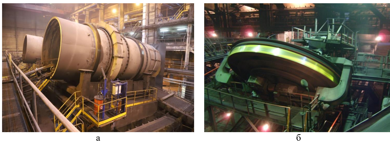
Рис. 1.5. Окомкователи: а – цилиндрический барабанный; б – дисковый
